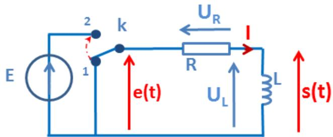
Sous l'effet de la tension continue  $E$  un courant  $I$  s'établit dans le circuit. La circulation de ce courant dans la bobine génère un champ magnétique qui tend à s'y opposer. Au cours de ce processus la bobine accumule une énergie de nature magnétique.
