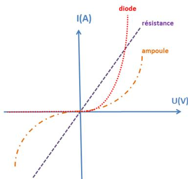
Dipôle récepteur ou passif, la caractéristique électrique passe par l'origine
