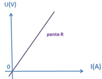
Si l'on reporte la tension en fonction du courant, on obtient la caractéristique tension-courant qui est une droite passant par l'origine dont la pente est  $R$ .
