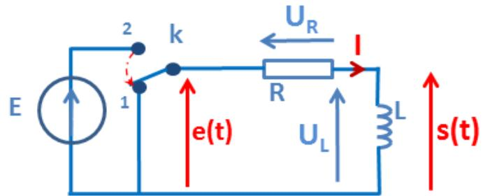
L'énergie emmagasinée dans la bobine est restituée. Le courant décroît continument tandis que la tension s'inverse brutalement. La bobine va se comporter comme un générateur. Ce processus dure jusqu'à l'équilibre où le courant dans le circuit est nul et où la bobine a restitué toute l'énergie emmagasinée.
