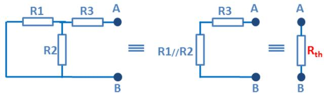
• Le circuit de départ peut être remplacé par le circuit ci-contre ou le courant qui circule dans R et  $R_{th}$  est :
