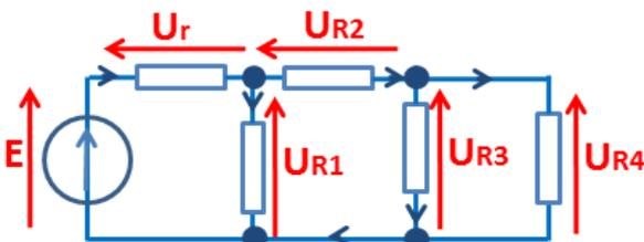
La somme algébrique des tensions aux bornes des dipôles d'une maille orientée aléatoirement est nulle :
