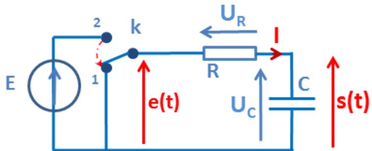
Les électrons précédemment accumulés sur l'armature inférieure ( $q_{inf} = -C.E$ ) vont venir combler le déficit d'électrons de l'armature supérieure ( $q_{sup} = C.E$ ). On constate que le sens des électrons et donc du courant vont s'inverser par rapport à la charge du condensateur vu juste avant. Ce processus dure jusqu'à l'équilibre où la charge portée par le condensateur est nulle et où il a restitué toute l'énergie accumulée pendant la charge.
