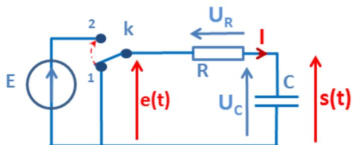
Sous l'effet de la tension continue  $E$  des électrons, en quantité égale, vont respectivement quitter et remplir les armatures supérieure et inférieure du condensateur. On assiste à la charge du condensateur au cours de laquelle il accumule une énergie de nature électrostatique.
