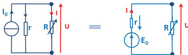
• A l'inverse, en calculant le courant lorsque  $R = 0$  (on met un court-circuit entre les deux points considérés) on montre que  $I = \frac{E_0}{r} = I_0$ .
