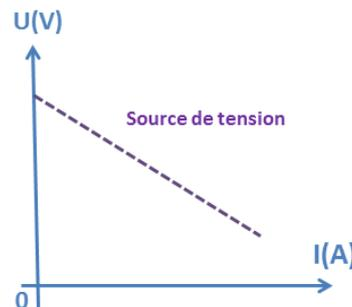
Dipôle générateur ou actif, la caractéristique électrique ne passe pas par l'origine
